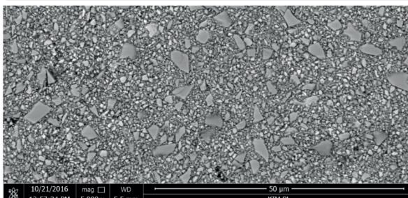
Distribución uniforme de las moléculas del relleno (SEM image x 5000)
