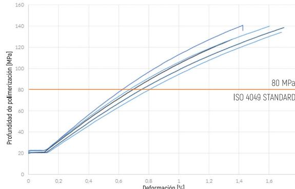
Resultados de las pruebas de resistencia a la flexión realizadas en conformidad con los requisitos de la norma ISO 4049
